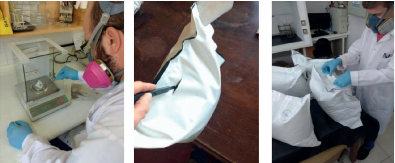
Figura 1: a) Izquierda: pesaje del fosforo de aluminio, b) Centro: abertura en la bolsa con maíz por donde se colocó el fosforo de aluminio. c) Derecha: cierre de la abertura mediante el pegado de tres cintas superpuestas.
