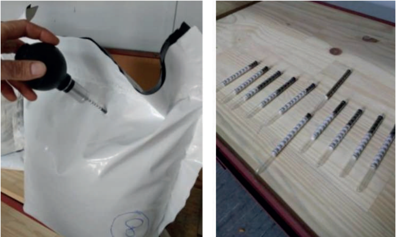
Figura 3: a) Izquierda: medición de la PH 3 en una bolsa con maíz. b) Derecha: pipetas utilizadas en las mediciones de concentración de PH 3 .
