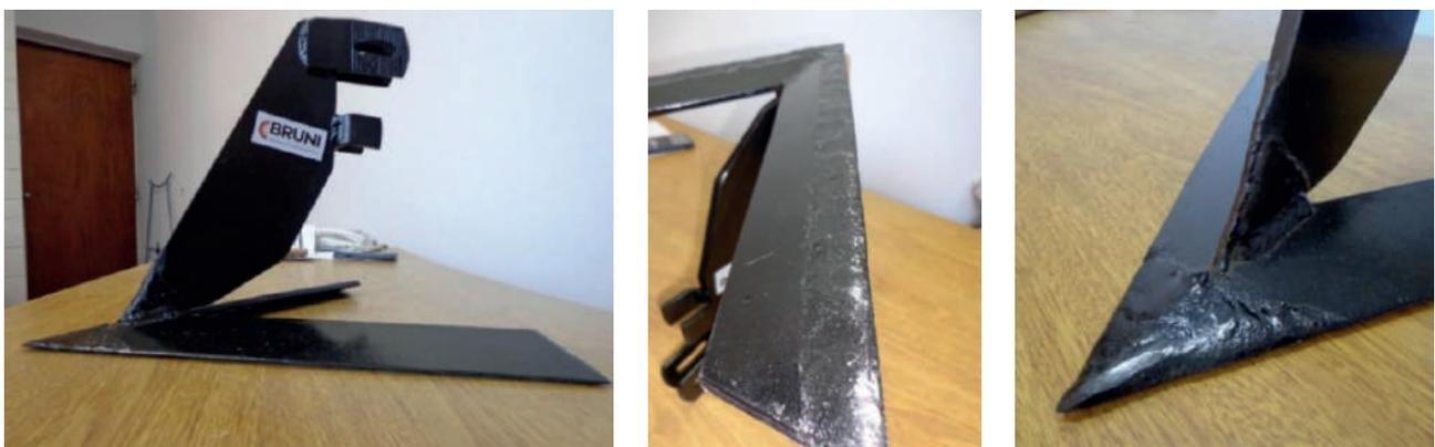
Figura 2: Izquierda: Vista en detalle del endurecimiento inferior de las alas de la reja. Centro: Cementado de la punta de reja. Derecha: Vista del timón en forma de rampa y el bajo perfil de ataque de la reja.
