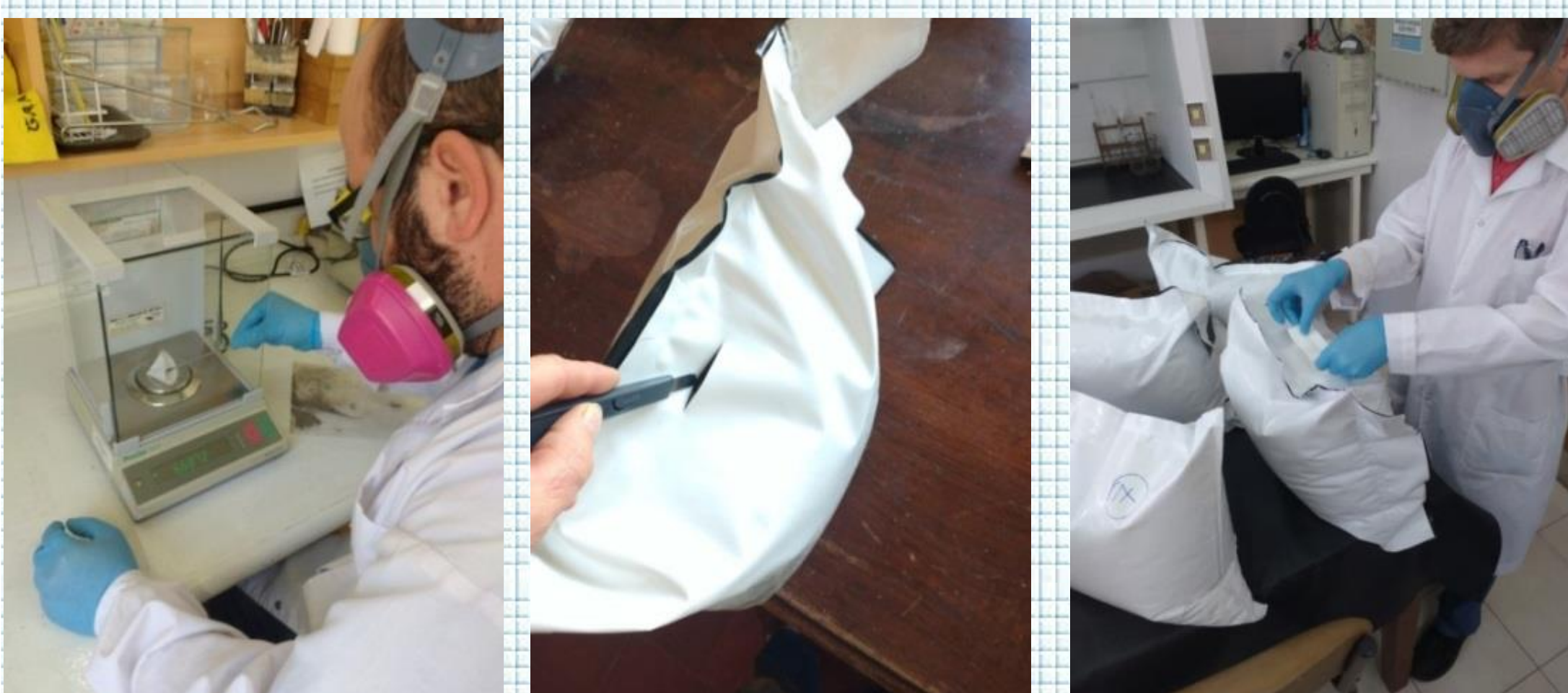
Figura 2: a) Izquierda: pesaje del fosfuro de aluminio, b) Centro: abertura en la bolsa con maíz por donde se colocó el fosfuro de aluminio. c) Derecha: cierre de la abertura mediante el pegado de tres cintas superpuestas.
