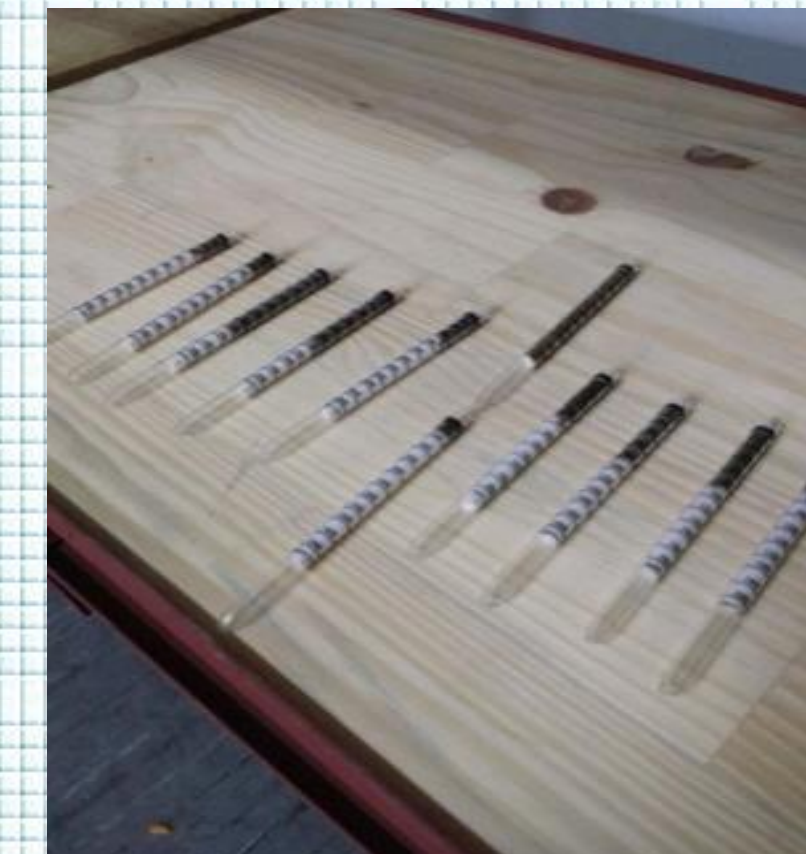
Figura 3: a) Izquierda: medición de la PH 3 en una bolsa con maíz. b) Derecha: pipetas utilizadas en las mediciones de concentración de PH 3 .
